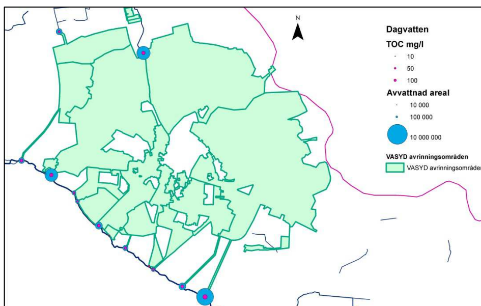
Exempelkarta 8b. Dagvattenavrinningsområden med utsläppspunkter till ytvattenrecipienter. Symbolstorlek ger en indikation på dagvattenmängd och -kvalitet, vilket kan bl a används som bedömningsgrund för att lägga upp en strategi för provtagning av dagvattenkvalitet.
