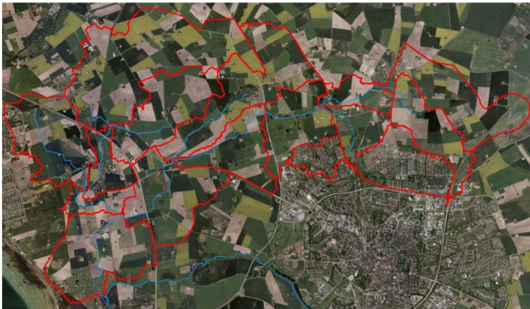
Figur 2.2 Delavrinningsområden i Önnerupsbäcken. Indelningen är gjord i GIS och är baserad på en marknivåer från den laserscannade höjdmodellen.
