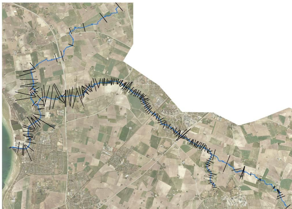
Figur 3.2 Tvärsektioner som använts i den hydrauliska modellen.
