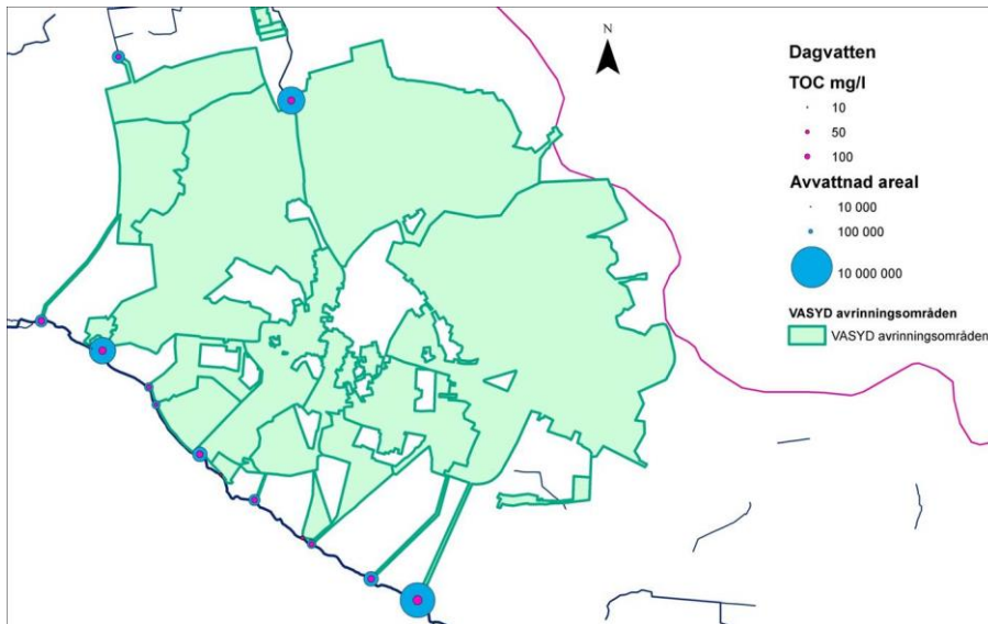
Figur 12. Planeringskarta över dagvattensavledning från Lund. De röda prickarna i de blå cirkelarna motsvarar partiklar och suspenderat material per volymenhet. (Bild från Lunds kommun).
