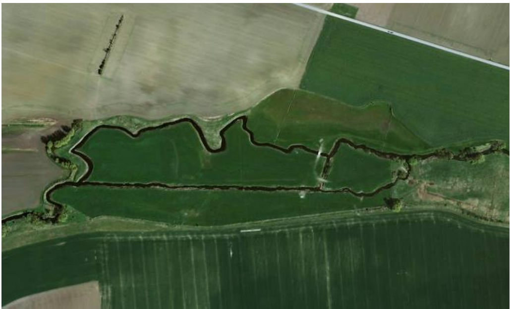
Figur 5. Höje å i nuläget. Den gamla åfåran är återställd. I det här fallet valde man även att behålla det gamla räta diket . (Bild från Eniro).
