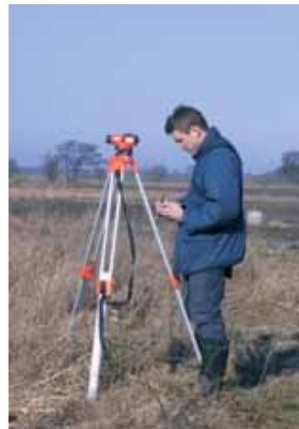
Rensningens djup bör kontrolleras med avvägningsinstrument.
