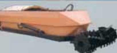
Båt med frontmonterad rotkultivator för vegetationsbekämpning i sjöar och vattendrag.
