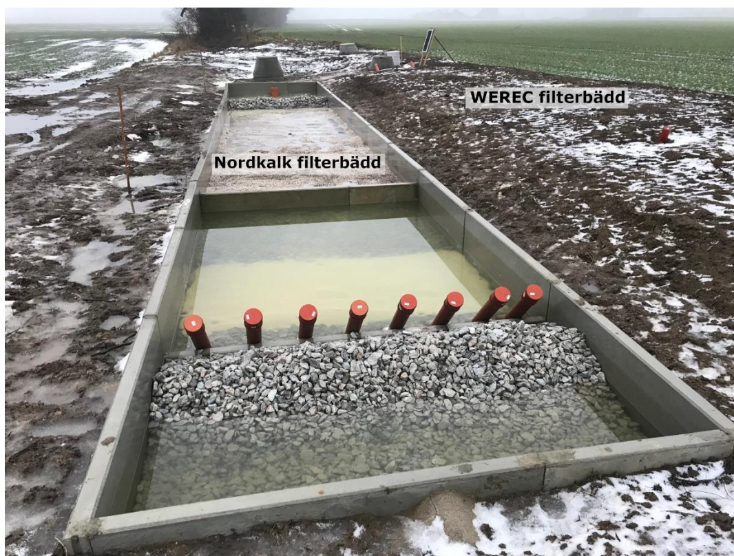
Figur 8. Filterbäddarna som de såg ut när de var nyanlagda. Nordkalks bädd i till vänster i bild och WERECS bädd (som är täckt med jord) till höger i bild. Vattenflödet går från kameran, genom filterbäddarna, vidare genom mätbrunnarna och sedan ut i befintligt kulvertsystem. I Nordkalk-bädden rinner vattnet genom ett lager makadam, över första mellanväggen, ner genom ett silande lager med filtermaterial, ut i slitsade spridarrör som löper genom nästa mellanvägg och fördelar flödet i filtermaterialet, genom vilket vattnet pressas upp till ytan, för att sedan rinna mot utloppet.
