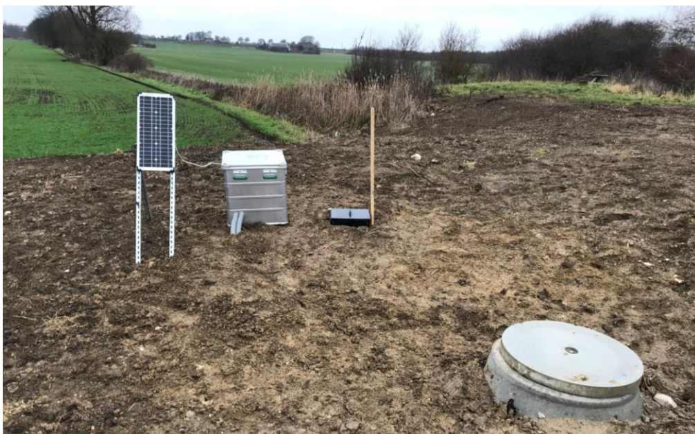
Figur 11. Provtagningsutrustning (en provpunkt) vid fördelningsbrunnen, uppströms filterbäddarna.
