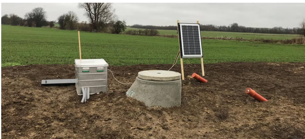
Figur 12. Provtagningsutrustning (två provpunkter) vid mätbrunnarna nedströms filterbäddarna.
