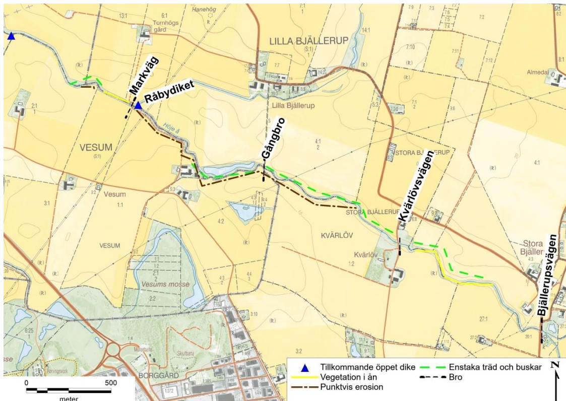
Figur 26. Höje å från Dynnbäcken till Stora Bjällerup. Åns slänter är på sträckan drabbade av kraftig erosion. Bakgrundskarta ©Lantmäteriet MS 2013/04204
