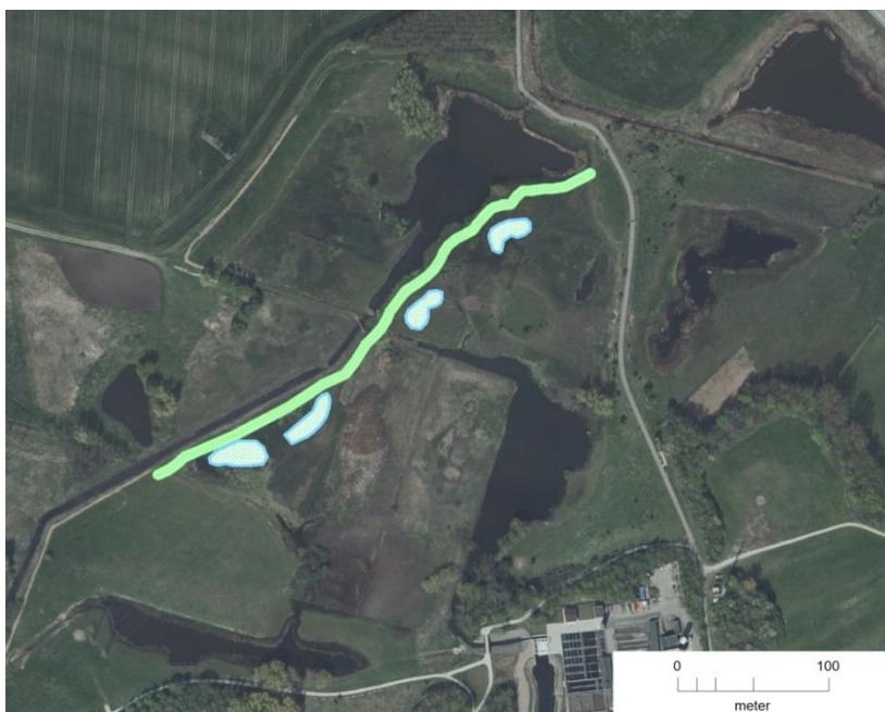
Figur 12. Exempel på hur små vattensamlingar (blått) kan anläggas längs med vallen (grönt) för att få fram schaktmassor till vallen. Efter en översvämning av marken dröjer sig vatten kvar i dessa områden.
