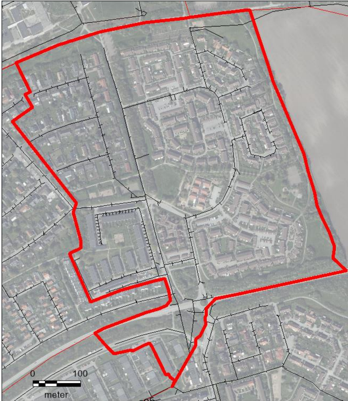
Figur 5 Delavrinningsområde Mårtens Fälad, typområde för villa- och radhusbebyggelse, klass 2. Med dagvattenledningsnät (svarta linjer), och delavrinningsområdesgränser (röda linjer). Flygbild Lunds kommun, 2014.
