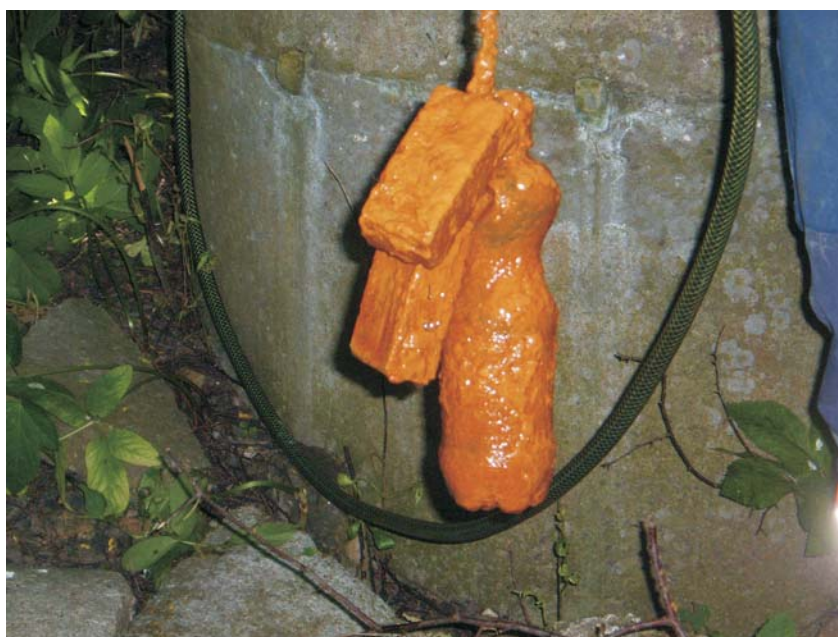
Provtagare från första utsättningen i brunnen "Möllevången ned". Provtagaren har fått tydliga järnutfällningar redan efter två veckor.
