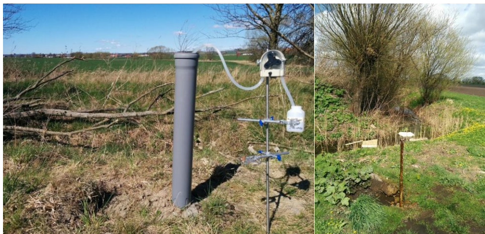
Figur 1 Provtagning i grundvattenrör vid Kyrkheddinge med hjälp av manuell hydraulisk pump. Ovan till höger: Provtagningsplatsen Nöbbelövs källa.
