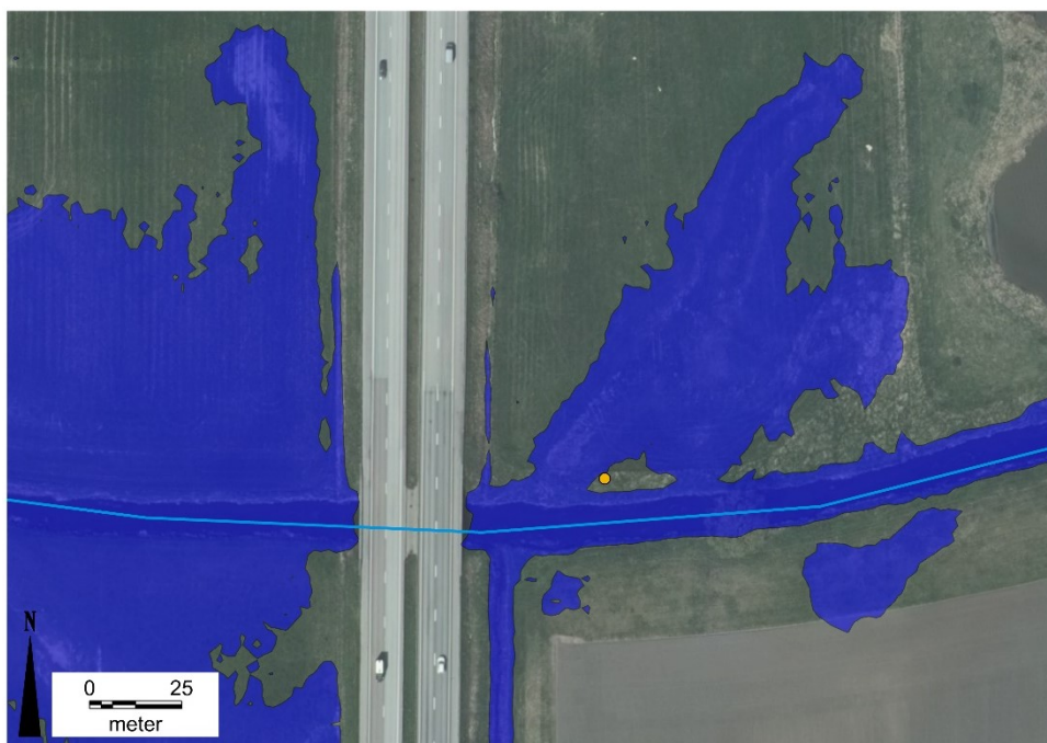
Figur 12 Blå, skuggad yta motsvarar den högsta uppmätta vattennivån under mätperioden, +2,18 m. Gul punkt motsvarar mätstationens läge.
