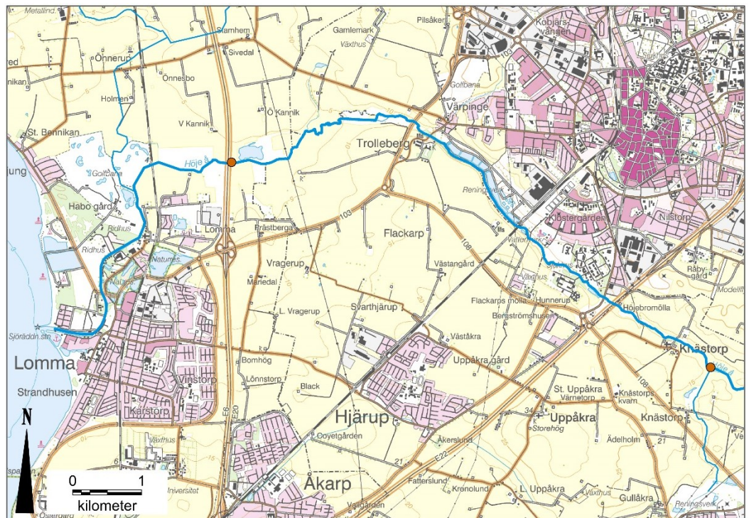
Figur 1 Mätstationernas läge längs Höje å är utmarkerade med orangea punkter. Den ena ligger precis uppströms väg E6 och den andra vid Dynnbäckens mynning i Höje å. (Bakgrundskarta ©Lantmäteriet)
