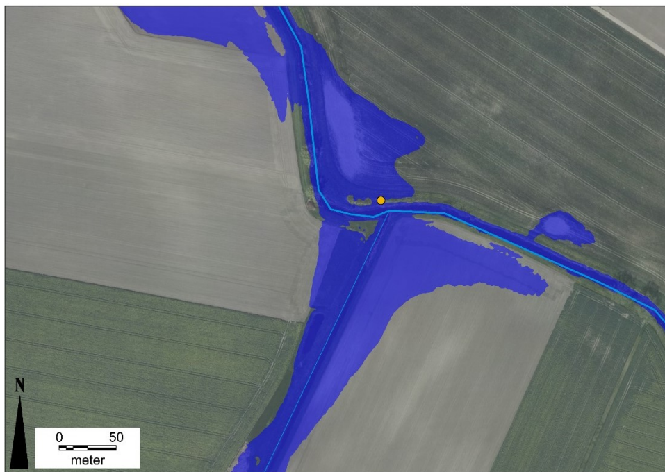
Figur 8 Blå, skuggad yta motsvarar den högsta uppmätta vattennivån under mätperioden, +10,78 m. Gul punkt motsvarar mätstationens läge.
