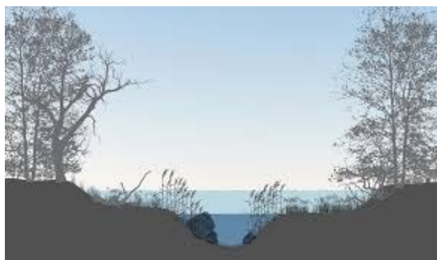
Figur 14 Schematisk bild över hur ett tvåstegsdike med terrasser kan se ut i sektion. (Jordbruksverket, 2017:4)
