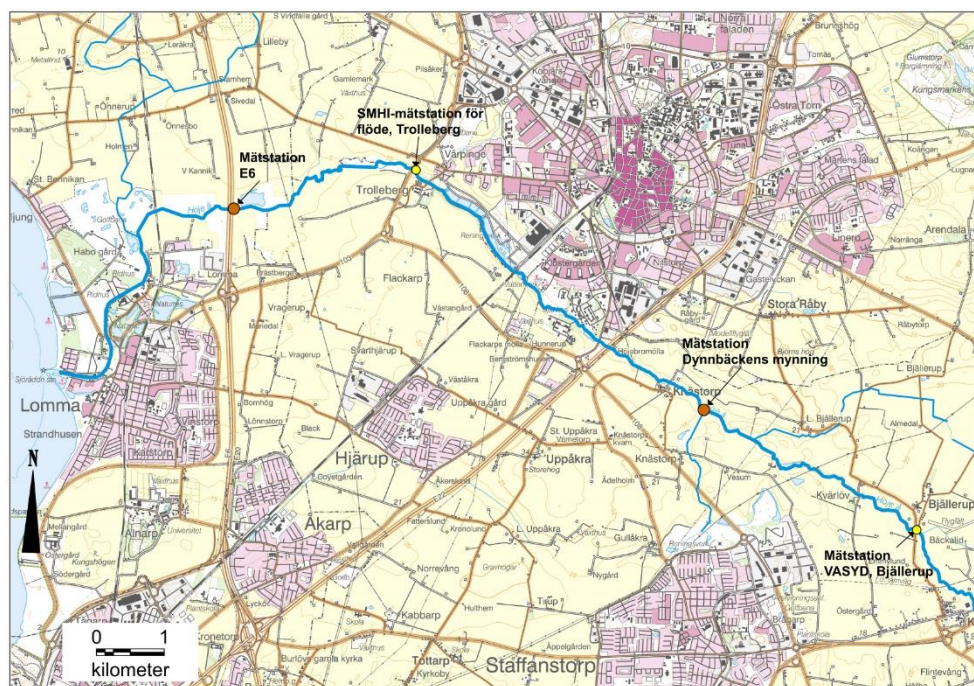
Figur 1 Mätstationernas läge längs Höje å är utmarkerade med orangea punkter. Den ena ligger precis uppströms väg E6 och den andra vid Dynnbäckens mynning i Höje å. Gula punkter anger positionerna för SMHI:s mätstation i Trolleberg och VA SYDs mätstation vid Bjällerup (Bakgrundskarta © Lantmäteriet)
