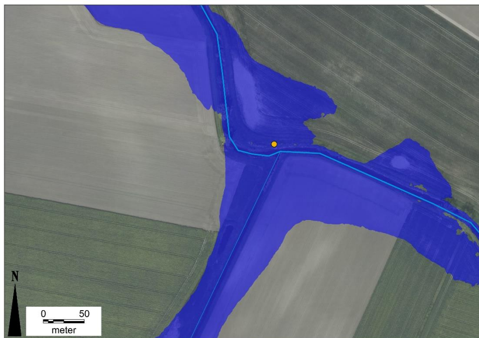
Figur 8 Blå, skuggad yta motsvarar den högsta uppmätta vattennivån under mätperioden, +11,20 m (teoretiskt översvämmat område). Gul punkt visar mätstationens läge. (Bakgrundskarta © Lantmäteriet)
