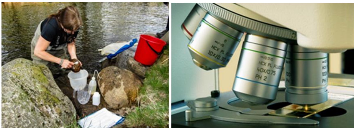
Figur 17. Provtagning av kiselalger görs i första hand genom borstning av stenar varefter kiselalgspreparat framställs och analyseras i mikroskop i 1000 gångers förstoring (objektiv 100x), © Medins Havs och Vattenkonsulter AB.
