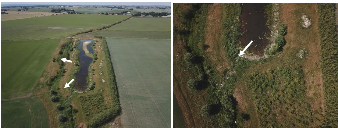
Bild 12. T.v. Översiktsbild med översta pilen som markerar munkens placering och nedersta bräddningen; T.h. Körbar stensatt bräddning över vallen till närliggande recipient (dike/vattendrag).
