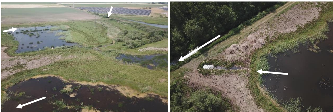
Bild 53. T.v. Översikt över våtmarksområdet som delas upp i flera sammanhängande områden, inlopp från dike och annan våtmark; T.h. Utloppet är ett öppet utlopp och stensatt samt två mindre gummidämmen, sedan leder en trumma under en körväg ut till ett större dike.
