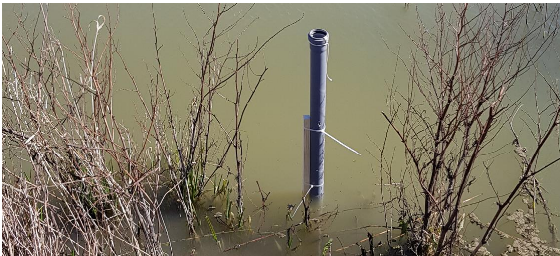
Figur 21 Tryckgivarna har hängts upp i plaströr som i sin tur varit förankrade i käppar nedslagna i dammens botten.
