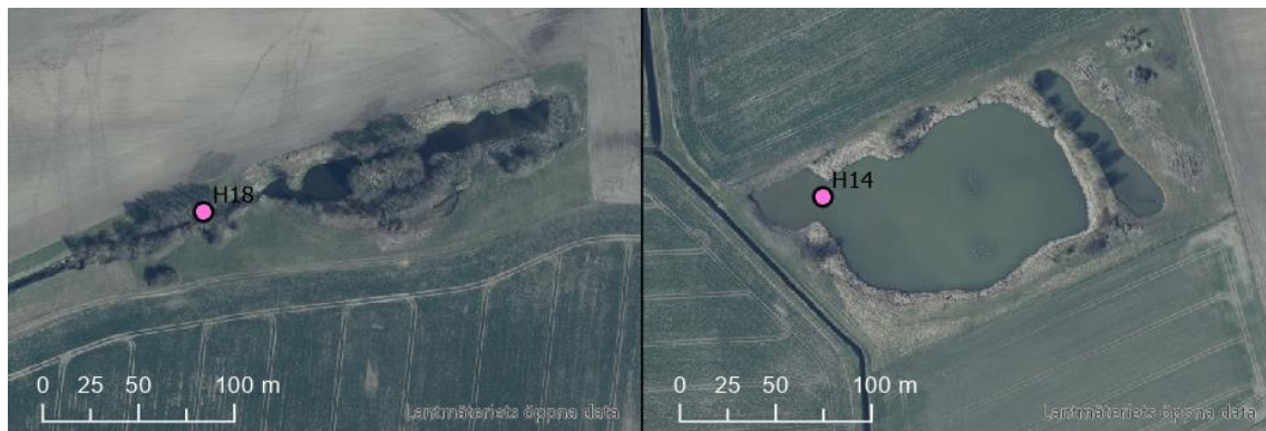
Figur 15 Damm H14 har inlopp via kulvert i sydöstra änden av den mindre dammen. Utloppsröret finns i dammen nordvästra ände. Damm H18 tar in vatten från två st kulvertar i dess östra ände. Utloppet sker via ett brett betongöverfall i västra änden.
