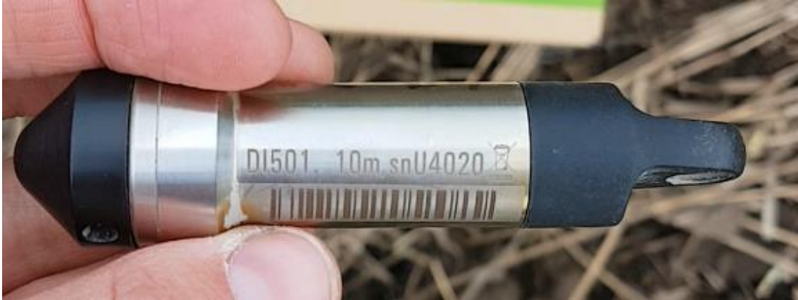
Figur 20 En diver (tryckgivare) är ca 10 cm lång och 2 cm bred. Den hängs upp lodrätt i en lina som fästs i ena änden av divern (den högra på bilden) och med andra änden i ett plaströr (se Figur 21).
