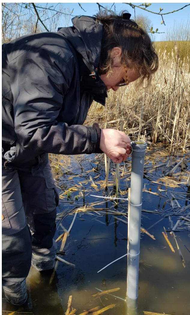
Figur 13 Montering av diver vid damm H25. 2020-04-07
